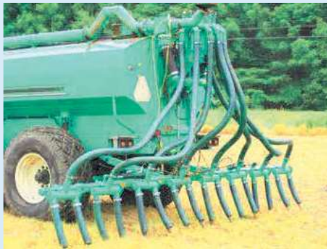
▲臭気抑制スラリー散布機による散布風景
