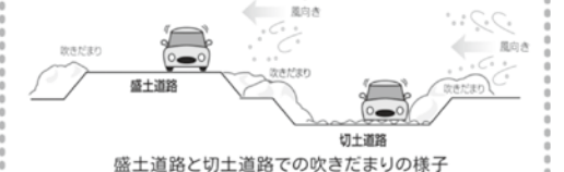
盛土道路と切土道路での吹きだまりの様子
