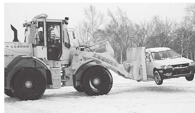
特殊機材を装着した除雪ドーザーによる車両の移動
