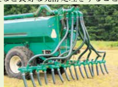
▲ 臭気抑制スラリー散布機による散布風景
