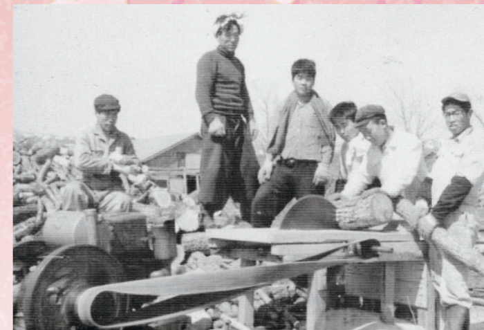
発動機で丸ノコを回転させ、丸太を薪にしている。発動機と薪切り台に動力を伝えるベルトがねじれているのは、丸ノコの回転方向を変えるため。
