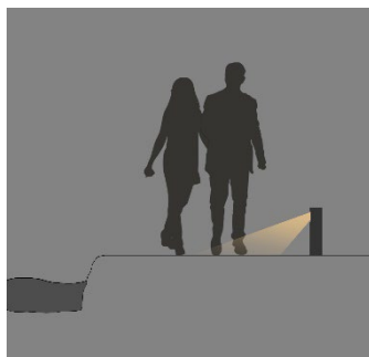
下方配光の器具で 遊歩道の明るさを確保
