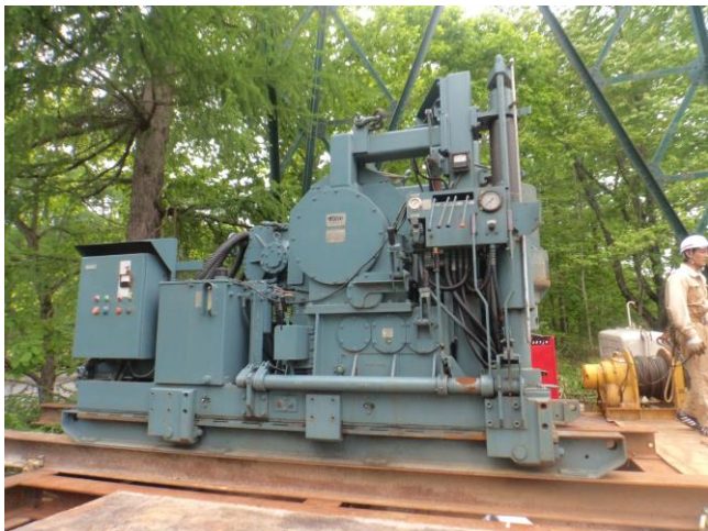
構造試錐井掘削に使用する機械(試錐機)
