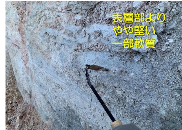
写真④ 粘性土（熱水変質）
